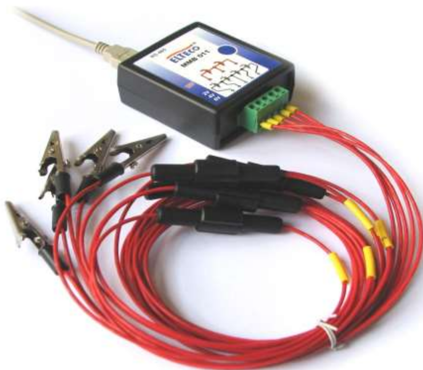
Рисунок 2 физическое подключение проводников к измерительному модулю ММВ 011
