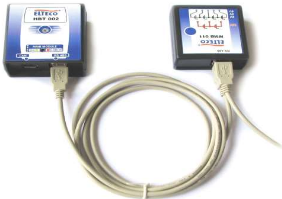
Рис. 3 физическое соединение модулей ММВ 011 и НВТ002
